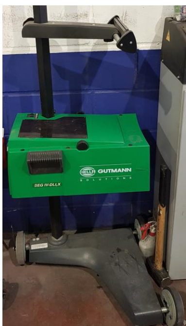
Maquina Hella Gutmann para regulación de faros Led-Xenón
